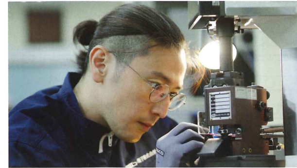
スタッフが半自動圧着機を使って加工している様子。高い技術を持つ技術者たちが、この会社にとって最大の財産だ
